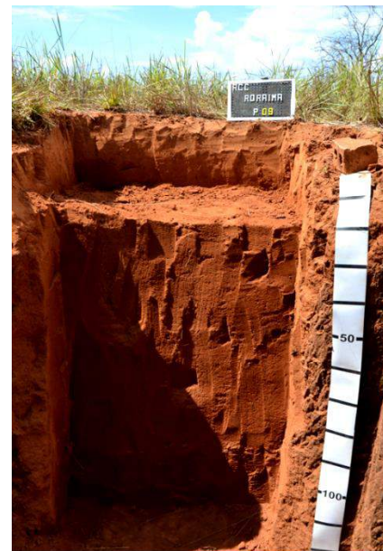
Figura 67 - Perfil de LATOSSOLO VERMELHO Distrófico típico (BR 401 – BVB – Bonfim) e LATOSSOLO VERMELHO Distrófico argissólico (Campus do Cauaé – UFRR).
