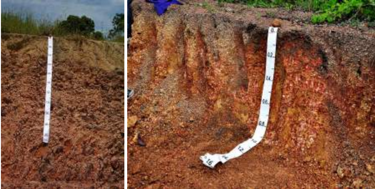
Figura 61 - Plintossolos Pétricos Concrecionários na porção central, em área de savana e em área de Floresta no sul do estado.
